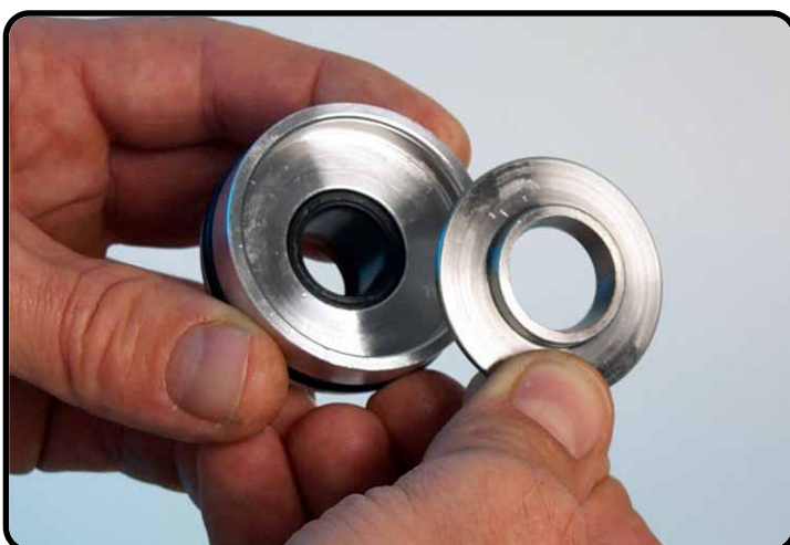
Replace the steel disc.
