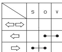
Kontaktbelegung - Lichtschalter (Typ CEV 9610)
