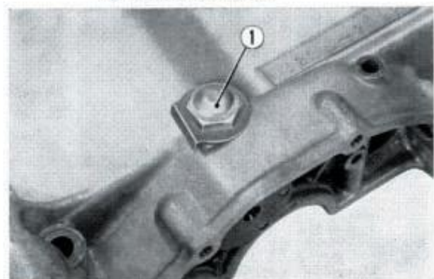
Fig. 122 ① Shift drum guide screw
