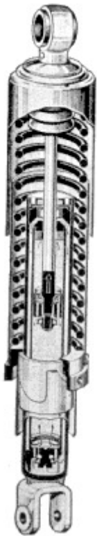
Bild 30. Federbein im Schnitt
