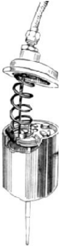
Bild 21. Der Nadelhalter mit Teillastnadel muß auf dem Gasschieberboden plan aufliegen!
