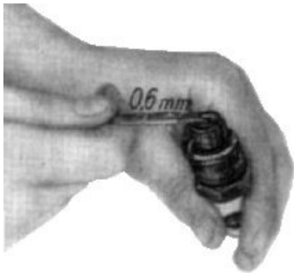
Bild 30. Elektrodenabstand prüfen
