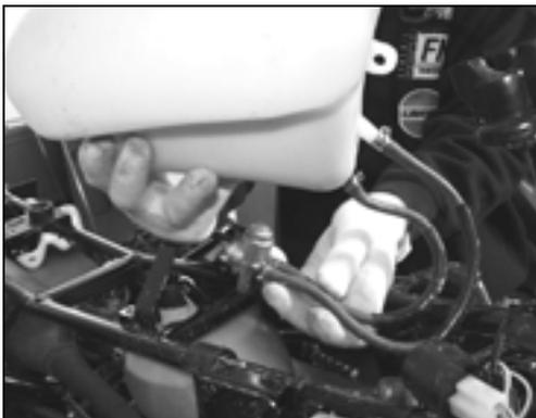
**6.1.13 REMOVING THE MIXER OIL TANK**
