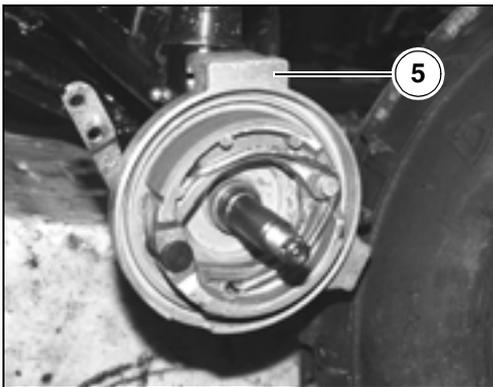
**6.4.2 REMOVING THE BRAKE DRUM**
