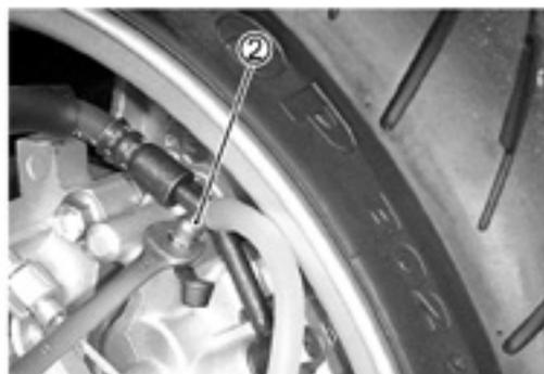
**AIR BLEEDING THE BRAKE FLUID CIRCUIT**
