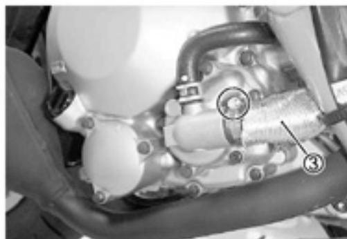
**AIR BLEEDING THE ENGINE COOLANT CIRCUIT**
