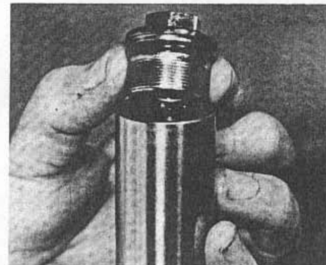
Bild 224 Verchromte Verschlussmutter entfernen
