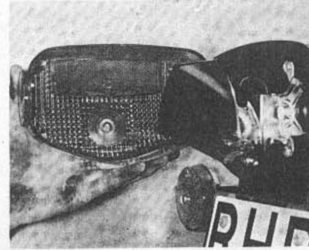
Bild 290 Streuscheibe der Rückleuchte mit vier Schrauben gehalten
