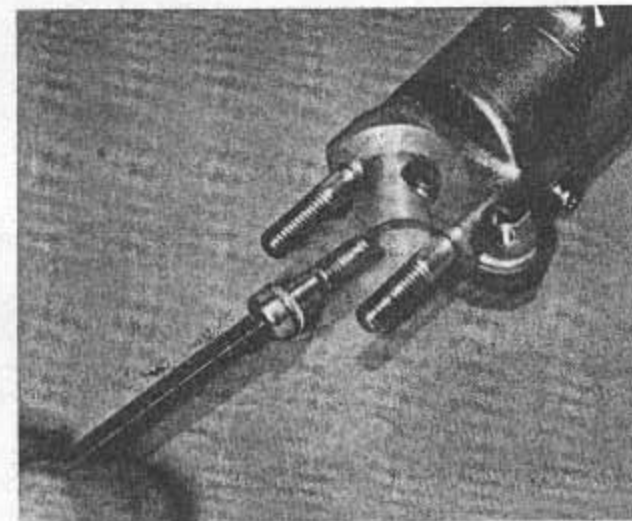
Bild 226 Innensechskantschraube aus Gabelgleitrohr entfernen
