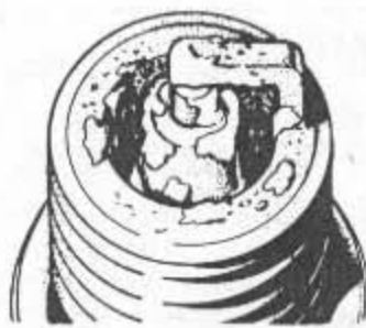
Weisse Ablagerungen und beschädigter Porzellanisolator deuten auf Überhitzung
