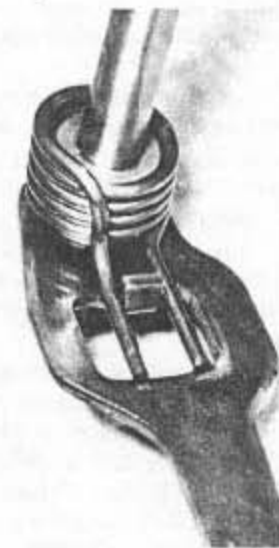
Bild 107 Schenkelfeder ist wie gezeigt anzubringen
