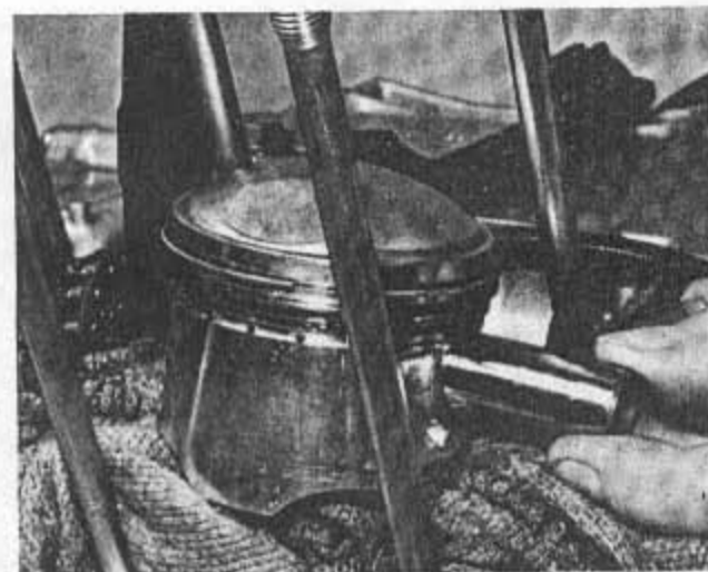
Bild 141 Öffnungen im Motorgehäuse mit Lappen verschliessen, bevor Kolbenbolzen montiert werden
