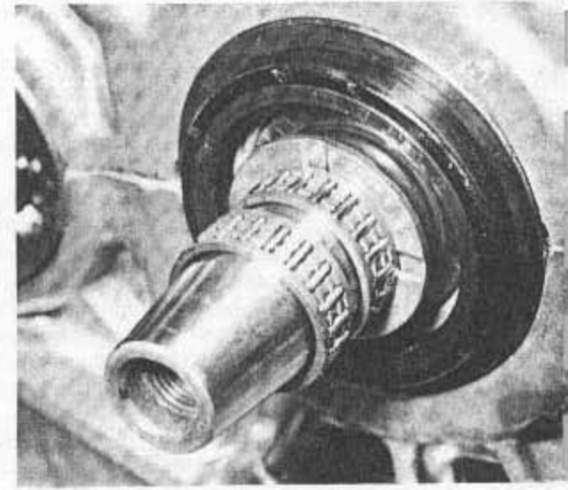
Bild 128 Kupferscheibe und zwei Nadellager einbauen
