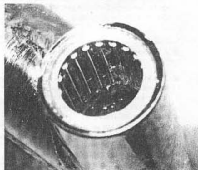
Bild 244 Lager lässt sich mit langem Durchschlag austreiben
