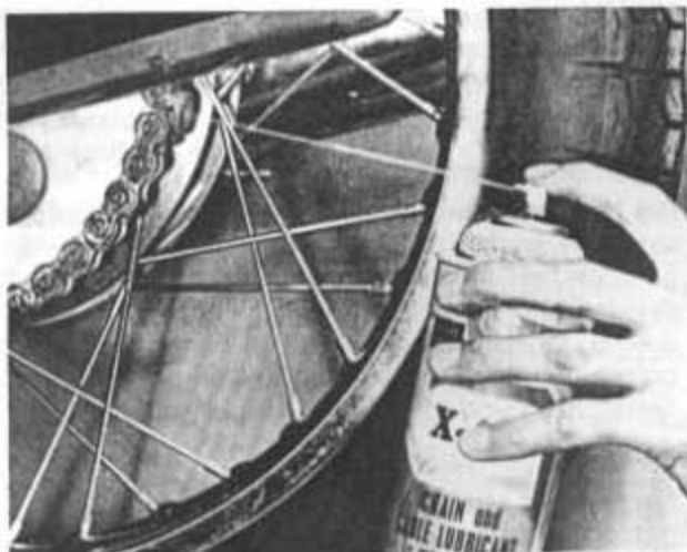
Bild 5 Kette lässt sich in eingebautem Zustand behelfsmässig abschmieren. (Bei Ketten mit O-Ringen keine Sprays verwenden!)
