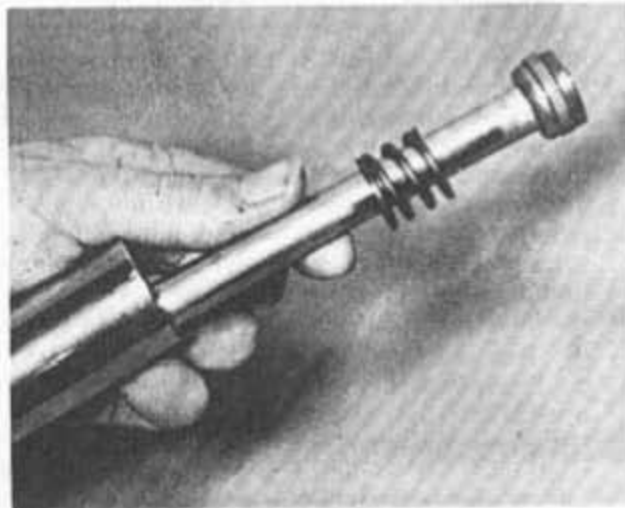
Bild 229 Standrohr umdrehen, um Rohr auszubauen
