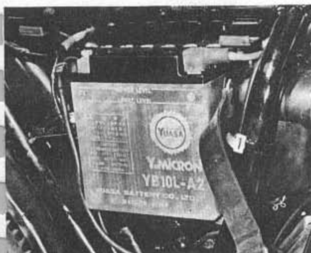
Bild 281 Seitendeckel abbauen, um Zugang zur Batterie zu erhalten
