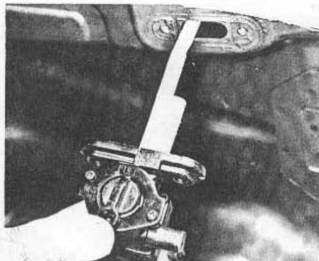
Bild 171 Kraftstofffilter wird mit Hilfe einer weichen Bürste in Kraftstoff ausgewaschen
