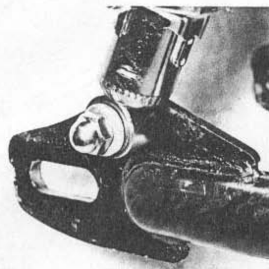
Bild 238 Federbeine an unterer Anlenkstelle lösen
