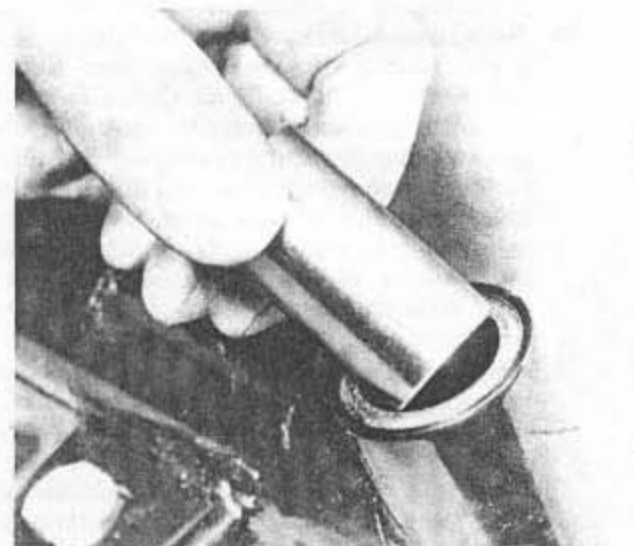
Bild 242 Innere (kurze) Lagerbuchsen herausziehen
