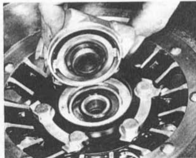
Bild 248 Klauen des Tachoantriebs müssen in Schlitze an der Nabe eingreifen
