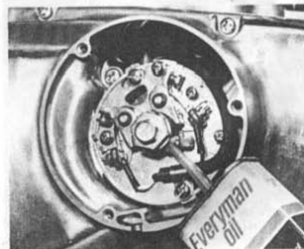
Bild 15 Schmierfilz mit einem Tropfen Allzwecköl versehen
