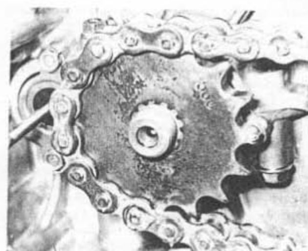
Bild 160 Ritzel in Kette einlegen und montieren
