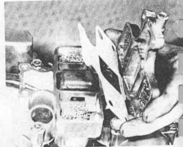
Bild 158 Vor Anbau des Entlüfterdeckels neue Dichtung auflegen
