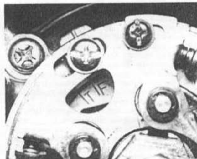
Bild 213 Sie sind durch das Fenster in der Unterbrechergrundplatte gut sichtbar
