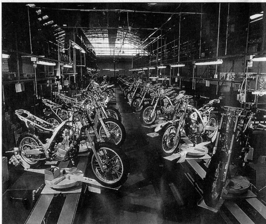
Vue d'ensemble de la chaîne d'assemblage de la BMW F 650 dans les ateliers Aprilia.
