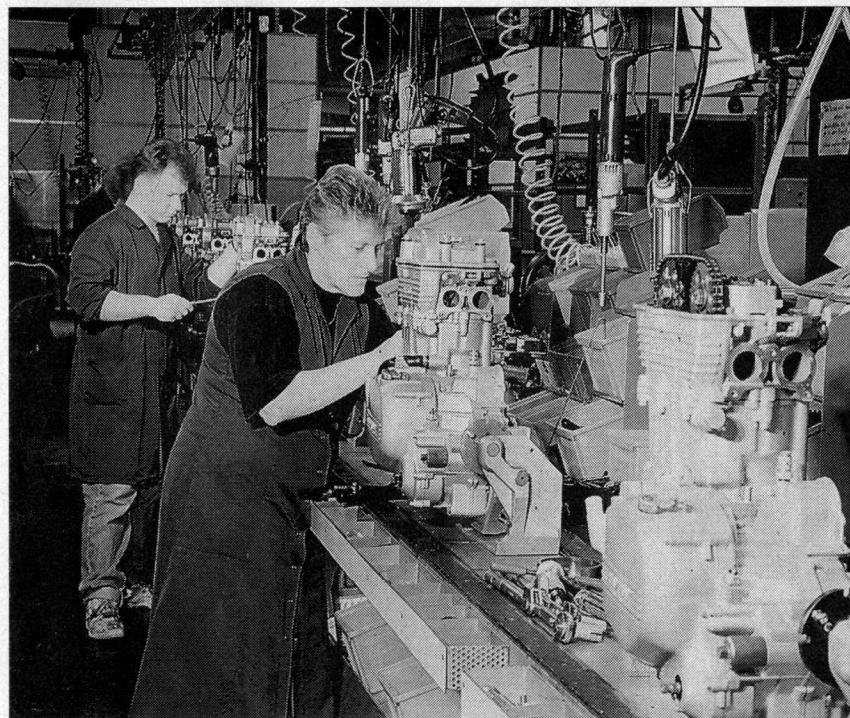
Les chaînes d'assemblage du moteur ROTAX des BMW F 650.
