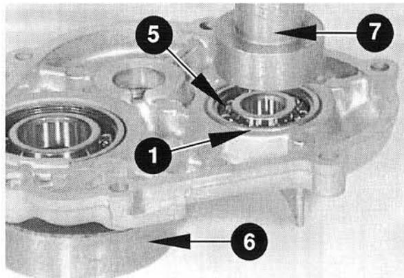
◆ **Nota:** Per evitare danneggiamento della superficie di tenuta, porre una vecchia guarnizione carter sotto il supporto estrattore.
