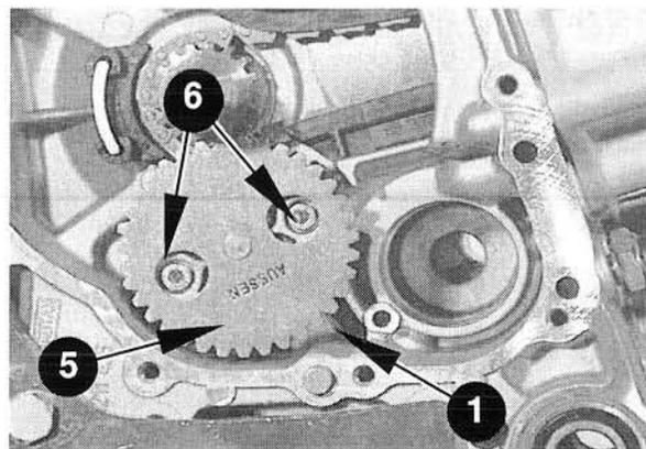
◆ **Nota:** All'installazione del rotore della pompa sostenerlo con la mano per evitare che cada e far attenzione al corretto posizionamento. Il corpo pompa deve essere piano rispetto al carter.
