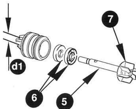
• Controllare se la girante ⑦ della pompa acqua presenta danneggiamento o deformazione, sostituire la pompa completa, se necessario.
