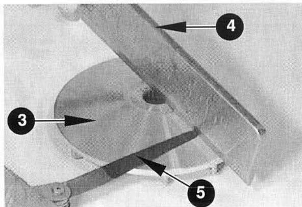
⇨ Controllare se la superficie di contatto ③ della puleggia primaria fissa con la cinghia presenta usura e/o danneggiamento. Determinare l'usura con un regolo ④ ed uno spessimetro ⑤.
