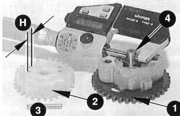
⇨ Controllare se i fianchi denti degli ingranaggi per pompa olio ① e pompa acqua ② presentano deformazione o rottura di materiale. Controllare la larghezza della sede di aggancio per la spina di trascinamento ③.
