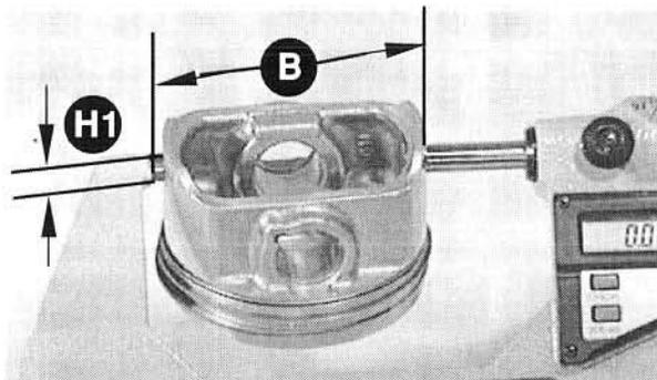
Misurare il diametro del pistone (**B**) alla altezza (**H1**) = 8 mm dal bordo inferiore del pistone a 90° rispetto all'asse dello spinotto, con un micrometro da esterni (= dimensione **B**).
