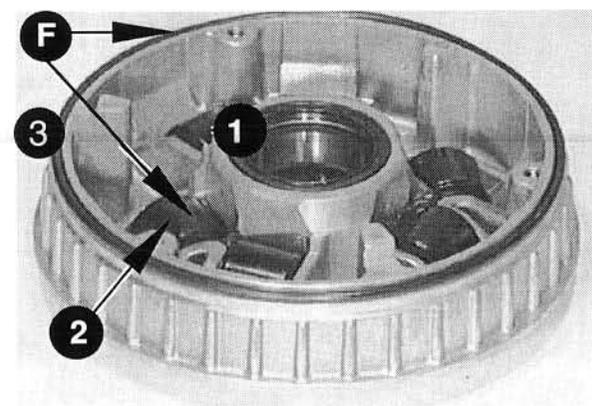
⇨ Controllare il diametro interno della bussola nella puleggia primaria mobile 12.
