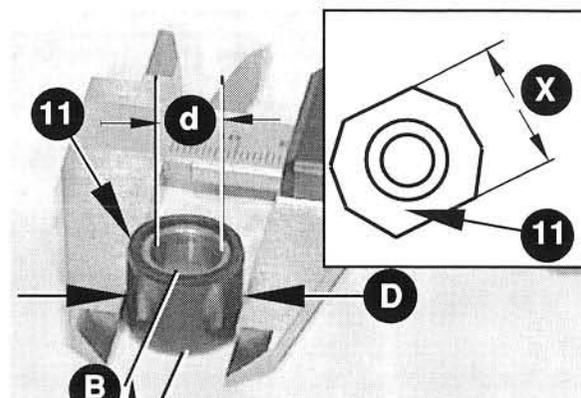
⇨ Controllare l'eventuale usura delle masse centrifughe 11:
