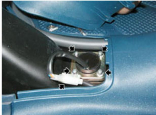
**3.3.4. REMOVING THE FUEL TANK**
