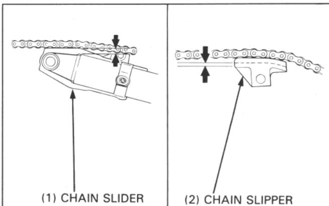
Vérifier si la chaîne secondaire et les joints toriques ne sont pas usés ou endommagés. Si la chaîne est excessivement usée ou endommagée, la remplacer.
