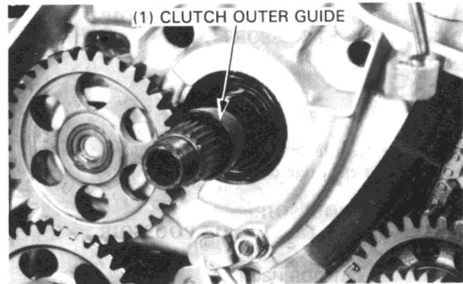
Débloquer le contre-écrou d'embrayage avec une mèche ou un chassoir.
