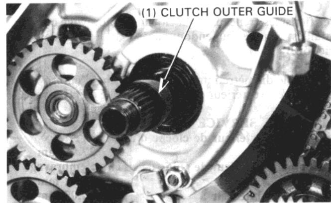
Mesurer le diamètre extérieur de l'arbre primaire au niveau du guide de cloche d'embrayage.
