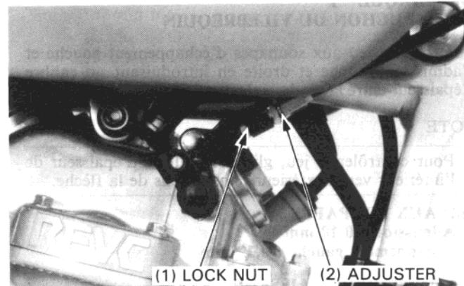
Pour régler le jeu, desserrer le contre-écrou et agir sur la vis de réglage jusqu'à ce que l'on ressente une légère résistance sur le calibre d'épaisseur.
