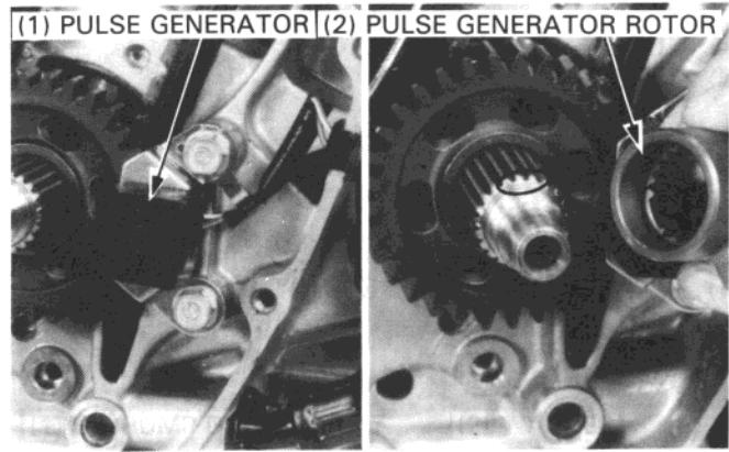
Déposer le rotor de générateur d'impulsions.
