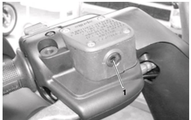
**RESTORING THE BRAKE FLUID LEVEL**
