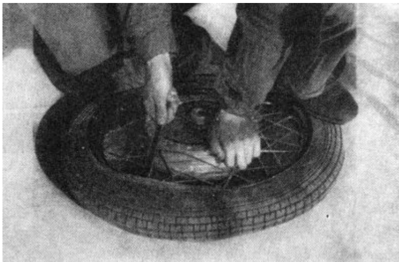
Bild 70. Beim Autmontieren wird der letzte Teil der Decke am Ventil über den Felgenrand gehoben
