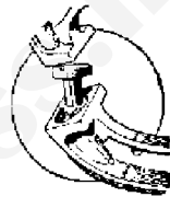
FIG. 29.—BRAKE SHOE WITH DETACHABLE HEEL PAD.
