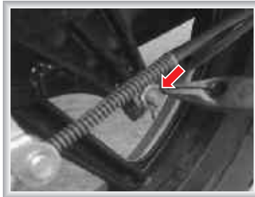
Torque Rod Nut
