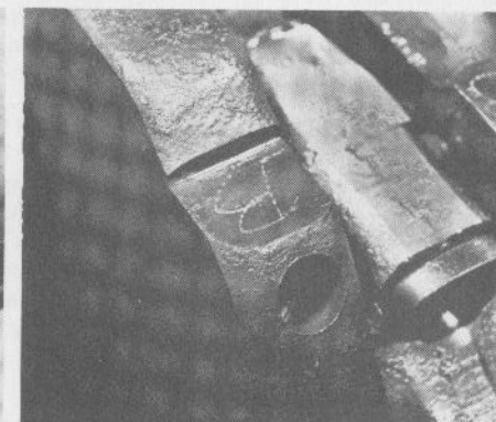
21.6B Lagerschaalcode op de krukswang
