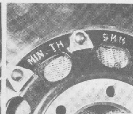
13.4 De minimale dikte van de remschijf staat op de schijf aangegeven
