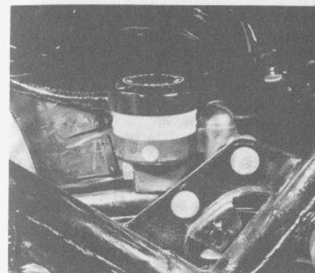
12.1 De hoofdremscilinder van de achterrem zit met twee bouten vast
