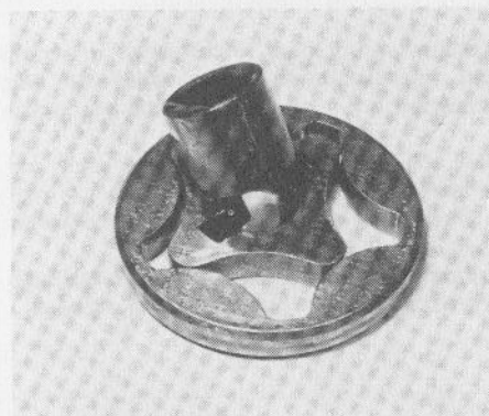
16.3C Controleer alle rotors op groeven en afschilferen
