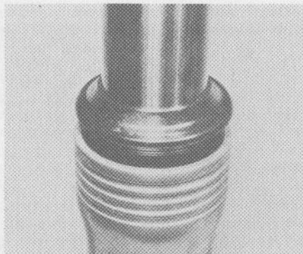
2j Controleer of de circlip goed geplaatst is voor je het stofrubber monteert
