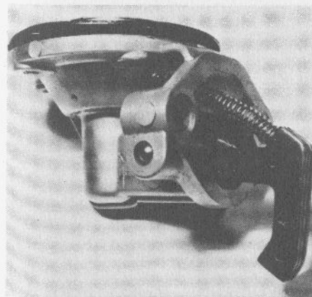
6.2A De benzinepomp is van het type waarvan de hefboom door een nok bediend wordt
