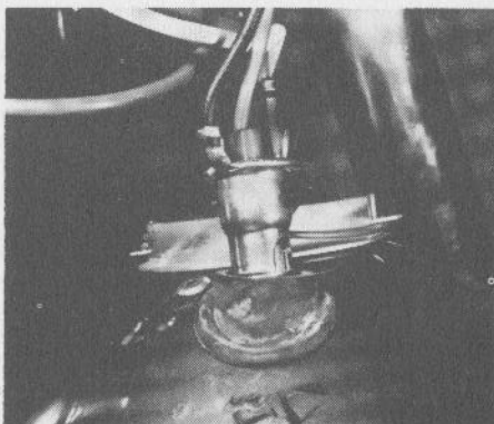
13.3C De stadslichthouder zit op zijn plaats gedrukt en ...
