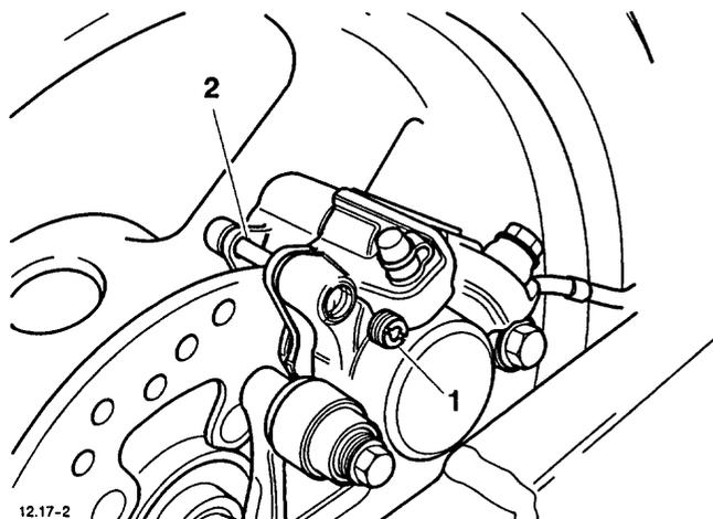
**1. Plug****2. Pad retaining pin**
