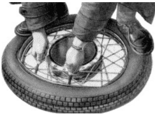
Bild 44. Reifenmontage
