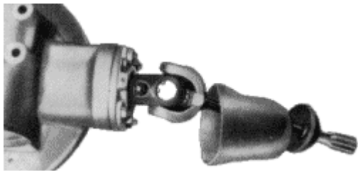
Bild 20. Kardanwelle mit Kreuzgelenk
