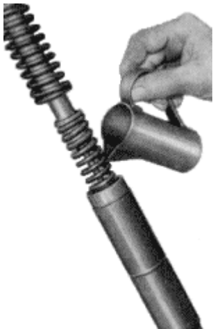
Bild 62. Füllen des Teleskoprohres vor dem Einbau mit Stoßdämpferöl
