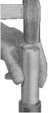
Bild 86. Einsetzen der oberen Führungsbuchse mit dem Dorn 05 MW 1-4
