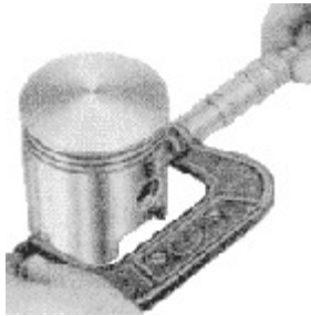
Bild 29. Kolben messen (Unterkante)
