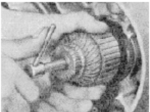
Bild 48. Ankerausbau
