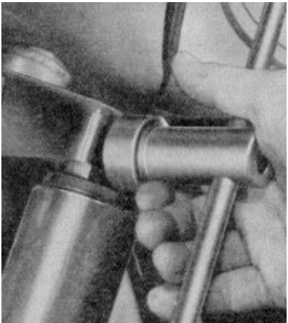
Bild 80. Lösen des Gewindestopfens mit Profilsteckschlüssel 05 MW 24-4
