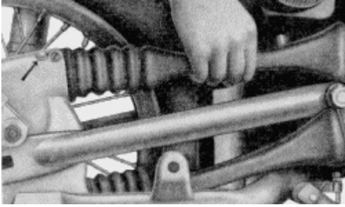
Bild 105. Prüfen des Kettendurchhanges
