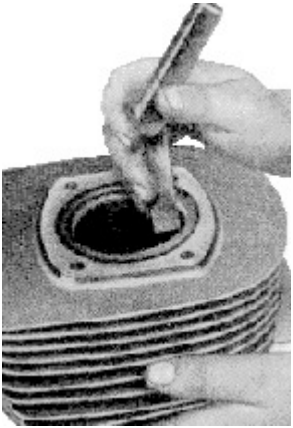
Bild 27. Messen des Kolbenringstoßmaßes
