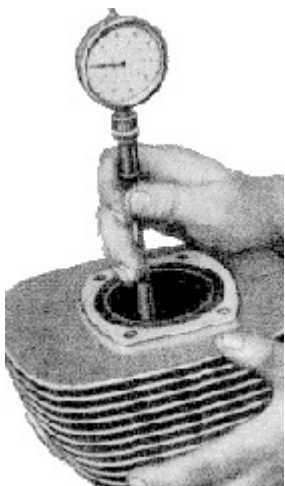
Bild 26. Zylindermessung an der Unterkante
