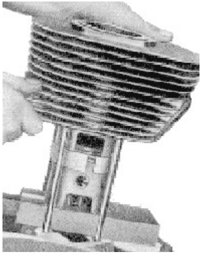
Bild 22. Aufsetzen des Zylinderkörpers unter Verwendung des Spannrings 05 MW 17-4 (ES 175 05 MW 35-4) und der Holzunterlage für d. Kolben
