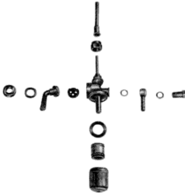
Bild 106. Kraftstoffhahn, zerlegt
