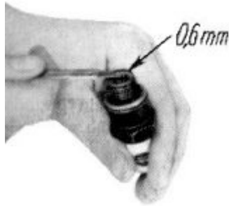
Bild 27. Elektrodenabstand überprüfen
