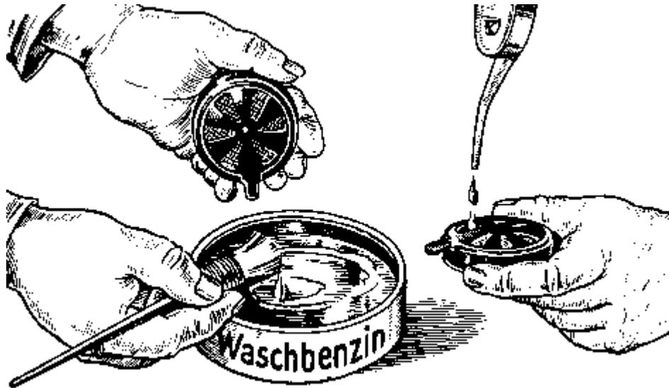
Ein verschmutztes Luftfilter bringt unregelmäßigen Motorlauf, Qualmbildung, hohen Verbrauch und schlechte Leistung. Ohne Luftfilter darf der Motor nie in Betrieb genommen werden.
