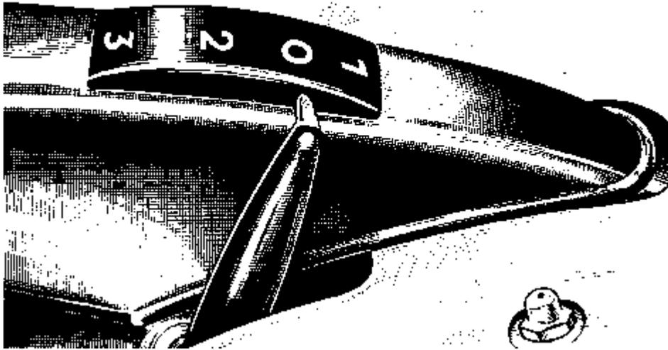
Die Leergangstellung befindet sich zwischen 1. und 2. Gang, sie ist durch leichten Druck auf den Schalthebel aus dem 2. Gang (bzw. durch leichtes Hochziehen des Hebels aus dem 1. Gang) ohne Schwierigkeiten zu finden.
