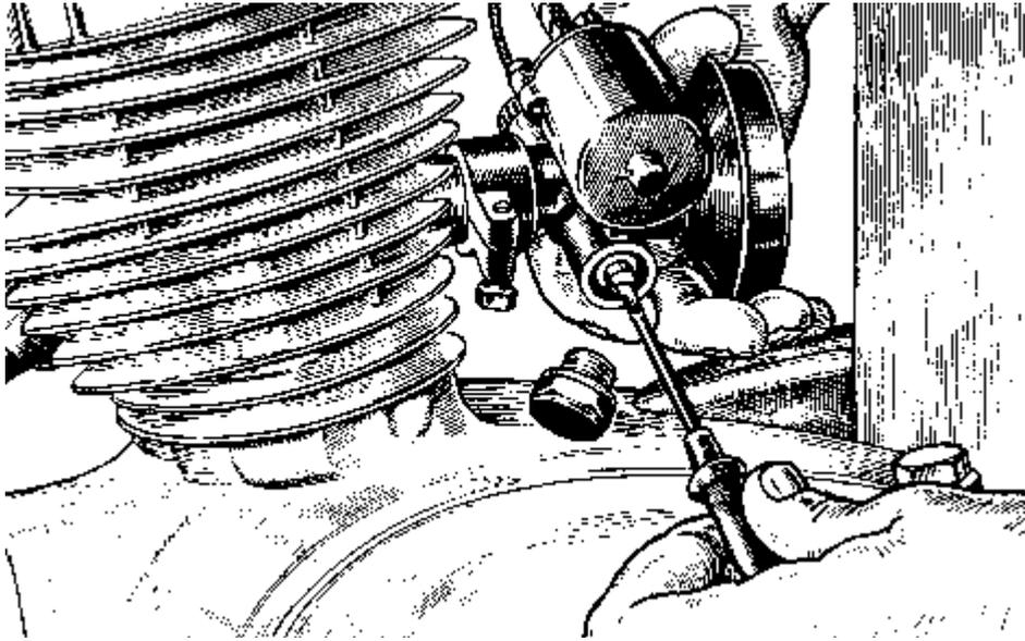
Nach der Einlaufzeit von etwa 1500 km ist die 80er Hauptdüse gegen eine 75er Düse auszutauschen (bei Vergaser Typ R 17).
