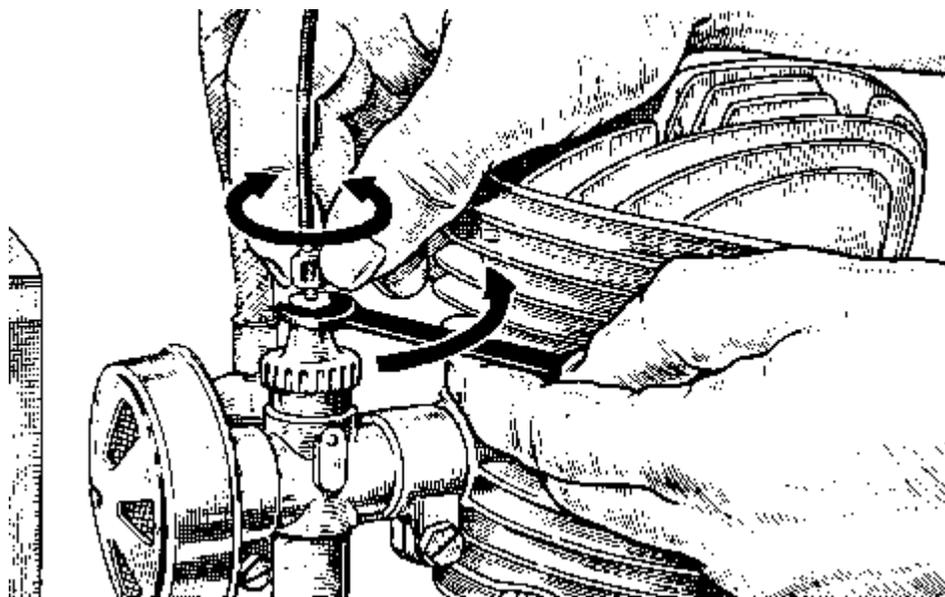
Die Einstellung des Leerlaufes erfolgt lediglich durch Heraus- und Hineinschrauben der Seilzugstellschraube am Mischkammerkopf. Hineinschrauben verringert die Leerlaufdrehzahl, Heraus-schrauben erhöht sie. Die Zusammensetzung des Leerlaufgemisches kann bei diesem Vergaser nicht verändert werden.
