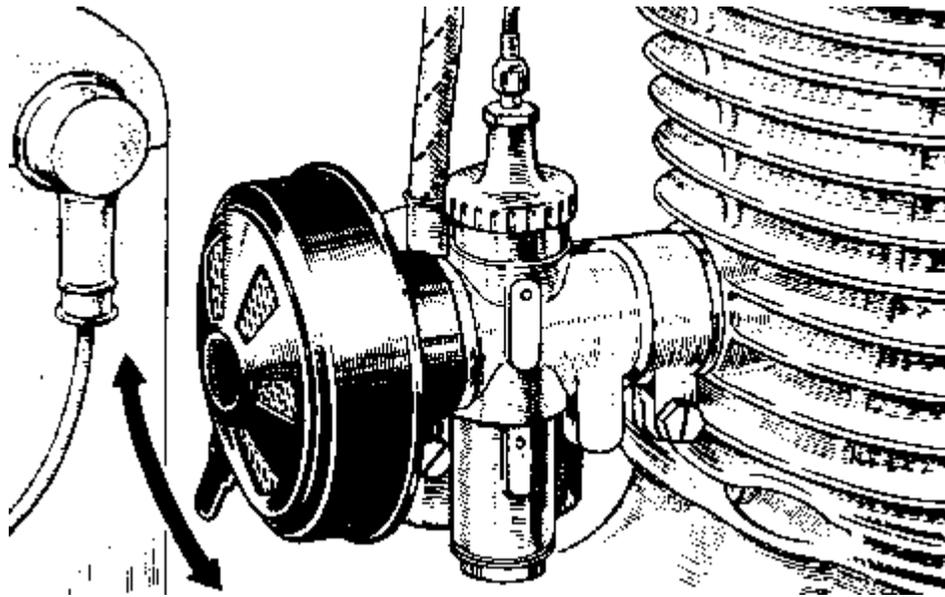
Ist der Motor angesprungen, so muß bei normaler Witterung die Luftklappe sofort, bei Kälte nach etwa 30 bis 50 Meter Fahrt geöffnet werden.
