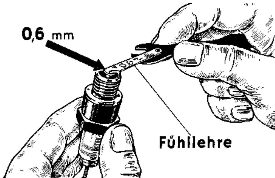
säubern (nicht ausbrennen, keine sogenannten Kerzenreiniger verwenden!). Ferner ist der richtige Elektrodenabstand wichtig; er soll 0,6 bis 0,7 mm, bei Isolatorkerze 0,55 mm betragen. Da sich dieser Abstand durch den Elektrodenbrand während des Betriebes vergrößert, muß die Seitenelektrode soweit nachgebogen werden, bis das richtige Maß, welches durch Zwischenschieben einer 0,6 mm starken Fühllehre bzw. dreier aufeinandergelegter Postkarten kontrolliert werden kann, wieder hergestellt ist.
