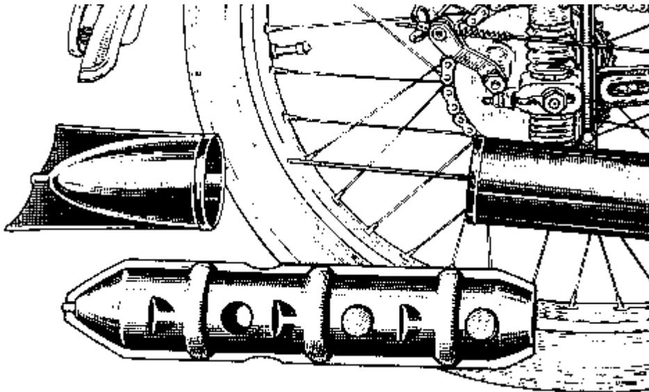
Der Auspufftopf der RT 125 ist demontierbar; nach Entfernen der am Topfende liegenden Mutter kann das Auspufftopf-Endstück abgenommen und der Topf-Einsatz herausgezogen werden. Die Reinigung erfolgt durch Auskratzen der Rückstände und, wenn notwendig, durch Ausbrennen des Einsatzes.
