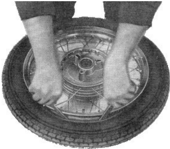
Bild 46. Reifenmontage
