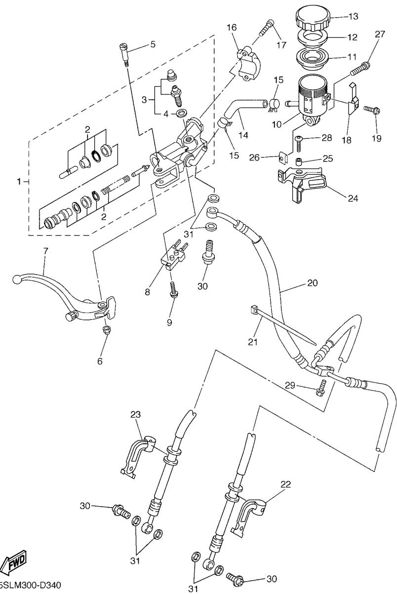
FIG. 34 FRONT MASTER CYLINDER
