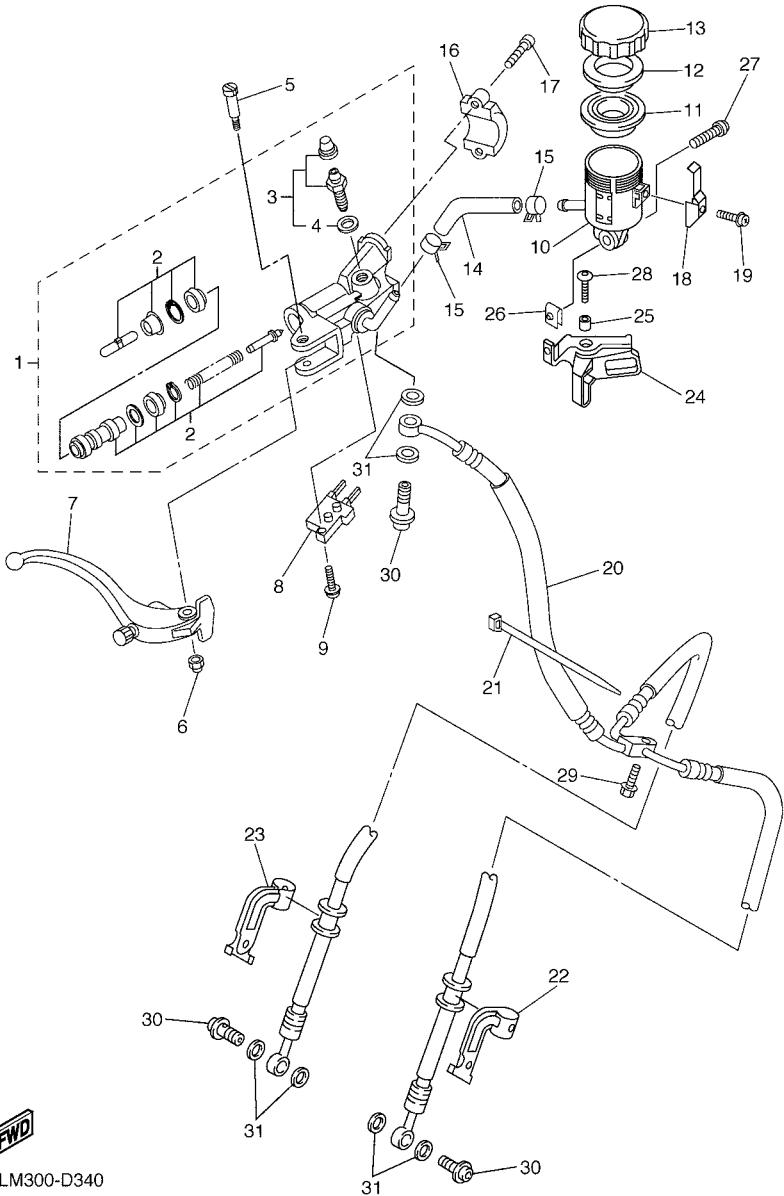
FIG. 34 FRONT MASTER CYLINDER
