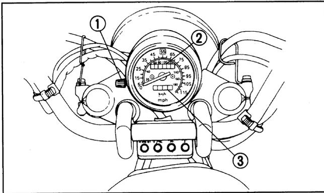
1. Reset knob    2. Odometer    3. Trip odometer
